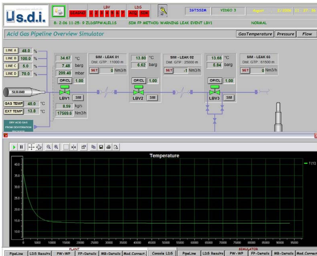
Figura 5: Trend identificativo del profilo di temperatura
