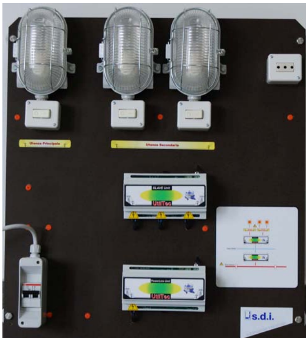
Quadro secondario collegato in power-line
